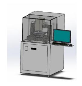
轮廓仪的性能测量模式移相干涉□PSI□□白光垂直扫描干涉□VSI□□单色光垂直扫描干涉□CSI□样品 台150mm/200mm/300mm样品台(可选配□XY平移□±25mm/150mm/200mm/300mm□倾斜: ±5°可 选手动/电动样品台CCD相机像素标配: 1280×960视场范围560×750um□10×物镜)具体视场范围取决于所配物镜及CCD相机光学系统同轴照明无限远干涉成像系统光源高效LEDZ方向聚焦80mm手动聚焦(可选电动聚焦□Z方向扫描范围精密PZT扫描(可选择高精密机械扫描,拓展达10mm)纵向分辨率□0.1nmRMS重复性\*0.005nm□1σ台阶测量\*\*准确度≤0.75%; 重复性≤0.1%,1σ横向分辨率≥0.35um□100倍物镜)检测速度≤35um/sec,与所选的CCD一般三坐标精度都在2-3um左右。进口轮廓仪美元报价
