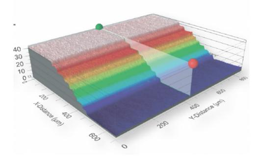
轮廓仪是用容易理解的机械技术测量薄膜厚度。它的工作原理是测量测量划过薄膜的检测笔的高度(见右图)。轮廓仪的主要优点是可以测量所有固体膜,包括不透明的厚金属膜。更昂贵的系统能测绘整个表面轮廓。(有关我们的低成本光学轮廓仪的資訊,请点击这里). 获取反射光谱指南然而轮廓仪也有不足之处。首先,样本上必须有个小坎才能测量薄膜厚度,而小坎通常无法很标准(见图)。这样,标定误差加上机械漂移造成5%-10%的测量误差。与此相比,光谱反射仪使用非接触技术,不需要任何样本准备就可以测量厚度。只需一秒钟分析从薄膜反射的光就可确定薄膜厚度和折射率。光谱反射仪还可以测量多层薄膜。轮廓仪和光谱反射仪的主要优点列表于下。如需更多光谱反射仪信息请访问我们官网。进口轮廓仪美元报价由于光罩中电路结构尺寸极小,任何微小的黏附异物和下次均会导致制造的晶圆IC表面存在缺陷。
