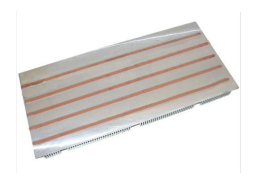
把散热器理解为换热器的话,那么,散热器+水冷板+水泵+管路,就形成了一个完整的液冷系统。水冷板负责吸收发热元件的热量传导到流经液体中,散热器则负责用翅片吸收被加的液体中热量,再通过外界的空气与翅片表面热交换,达到给元器件降温制冷的目的。
