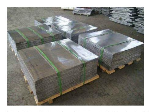
铅板,指是用的金属铅轧制而成的板材。具有很强的防腐蚀,耐酸碱的性能,在耐酸环境施工、医用防辐射□X光,CT室射线防护、加重、隔音等许多的方面,也是一种比较廉价的防辐射材料铅板,指用金属铅轧制而成的板材. 比重为11.345g/cm3□目前国内常见的厚度约为0.5-500mm□常用规格为1000\*2000mm□国内比较好的机器可制作\*\*宽2000mm□\*\*长30000mm□多采用1#电解铅制作,市面上也有采用回收铅制作而成的。其品质略差些,价格相差些许。 [1]
